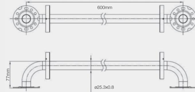
MANIGLIONE 600MM - Ø DIAMETRO 25MM
