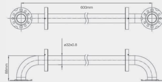
MANIGLIONE 600MM - Ø DIAMETRO 32MM
