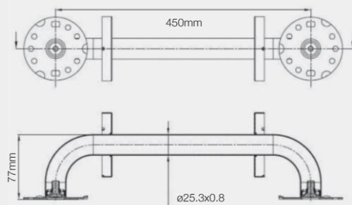
MANIGLIONE 450MM - Ø DIAMETRO 25MM
