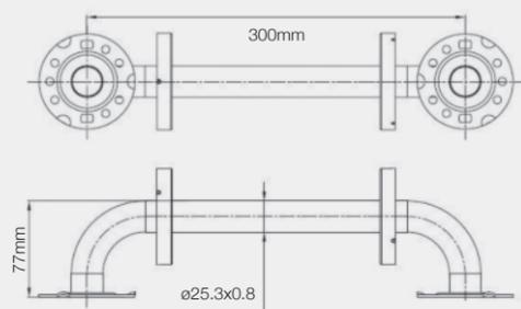
MANIGLIONE 300MM - Ø DIAMETRO 25MM
