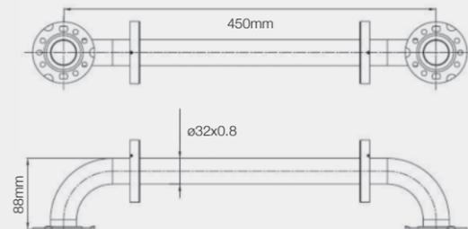
MANIGLIONE 450MM - Ø DIAMETRO 32MM
