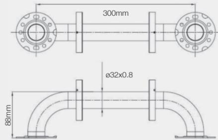
MANIGLIONE 300MM - Ø DIAMETRO 32MM
