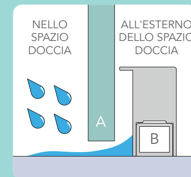
A - Vetro scorrevole B - Canale guida 2 - Profilo inferiore aggiuntivo
