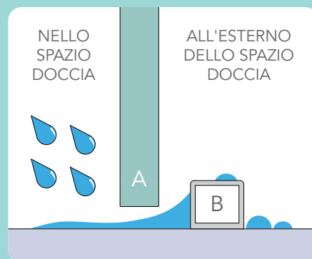
A - Vetro scorrevole B - Canale guida minimal
